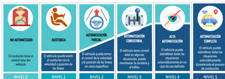
Fig. 1. Niveles de automatización de un vehículo definidos por el SAE.
